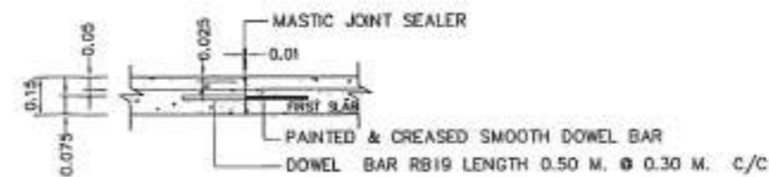
ขยาย CONSTRUCTION JOINT (รอยต่อดีซาด)
